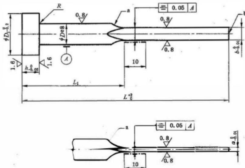
未注表面粗糙度  $R_a = 6.3 \mu\text{m}$ 。
